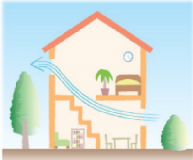
開口部を2か所以上開けて、風の入口と出口を確保。開口部の位置に高低差があると風が通りやすくなります。
